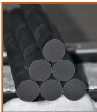
Obrázek 19 Moduly tvořící výplň jednotlivých segmentů adsorpčního kola
